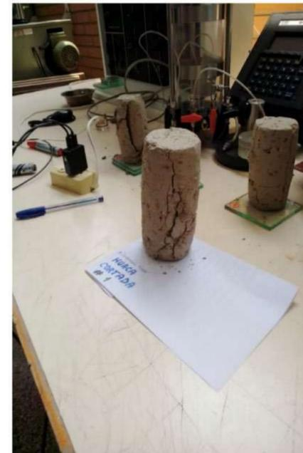
Muestra de la Huaca Cortada luego del ensayo de compresión libre no confinada. Fuente: Henry Torres.
